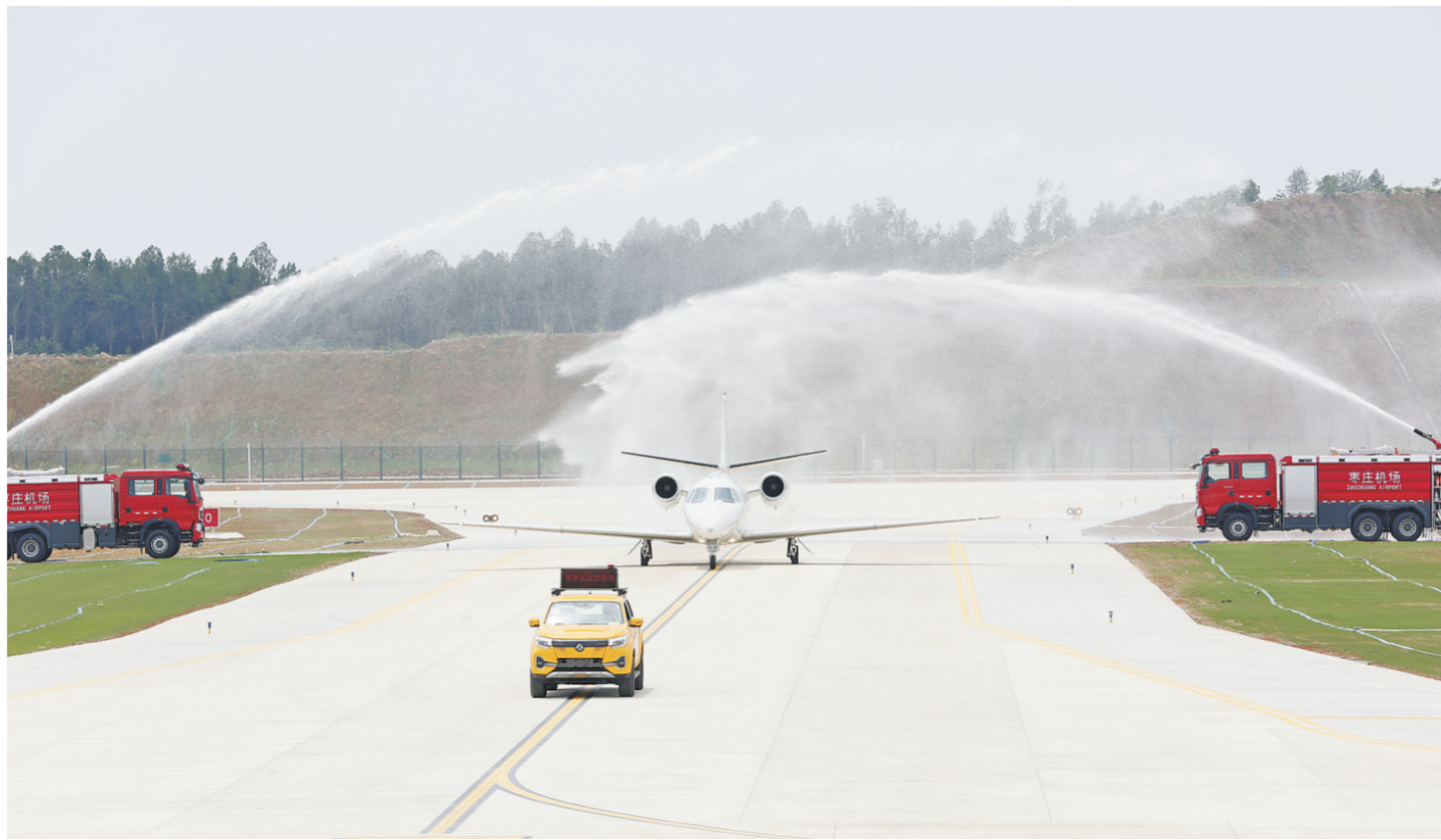
4月28日，一架由北京飞来的C-560型校验飞机平稳抵达枣庄翼云机场，在跑道上留下首条轮胎印痕。本次校飞将持续至5月3日，对机场导航设备、通信系统、助航灯光、飞行程序等关键设施开展全面检测校准，为后续试飞、行业验收和正式通航奠定基础。
