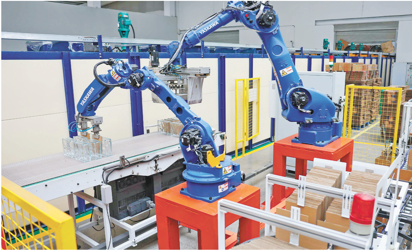
日前，德州天衢新区，德州瑞百利玻璃砖有限公司生产车间内，智能机械臂将玻璃砖打包装箱。
