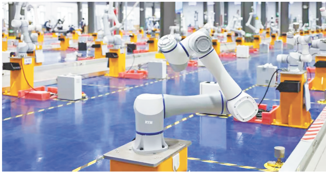
在越疆智能机器人日照生产基地，协作机器人智能机械臂正在进行出厂前的老化测试。（□资料图）
