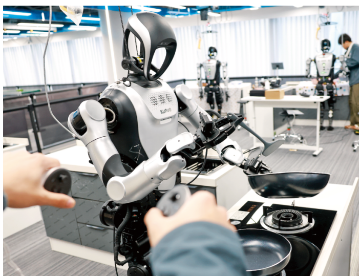
1月12日，在人形机器人数据采集训练场里，机器人在数据采集员的操控下，拿起炒锅和锅铲进行翻炒动作。
