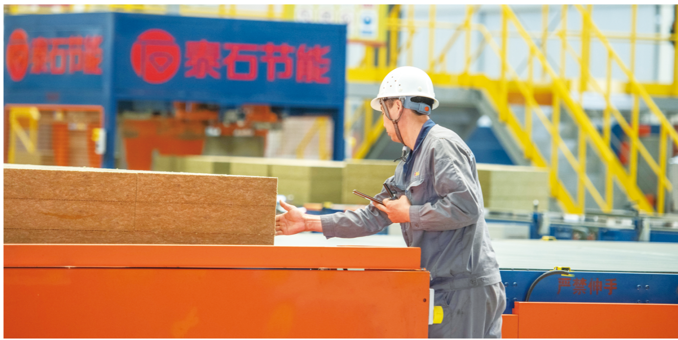
□ 记者 刘涛 报道 在泰山节能材料股份有限公司，一名工人在岩棉生产后工程区域，手持工具对岩棉板材进行人工抽检，确保产品符合生产标准。
