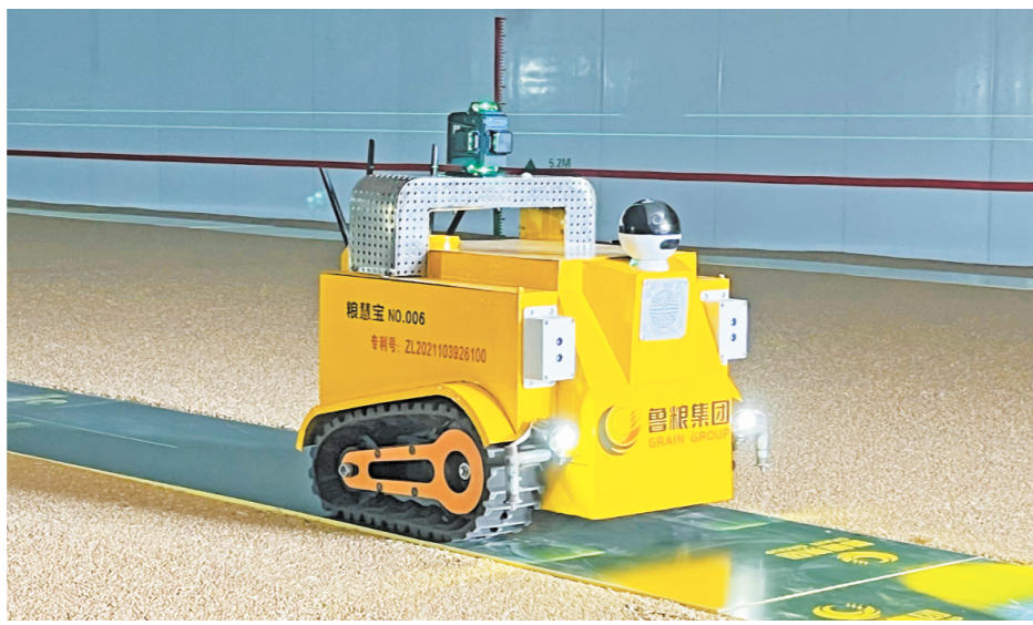
7月27日，山东省农业集团研发的“粮慧宝”粮仓智能巡检机器人在粮仓内工作。
