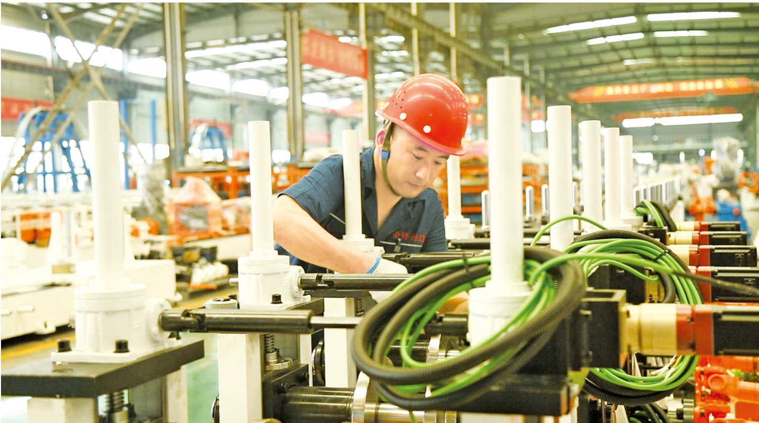
菏泽市加快推进制造业企业数字化转型和产业能级跃升,为全市工业经济高质量发展持续注入强劲数字动能。在山东金博利达精密机械有限公司生产车间,工人正在生产线上作业(上图)。全自动光伏支架生产线经过开卷、成型、冲孔、码垛等工序,从带钢变成C形/U形光伏支架,全程最快只需要十几秒钟。金博利达已成功入选“山东省制造业单项冠军”。
