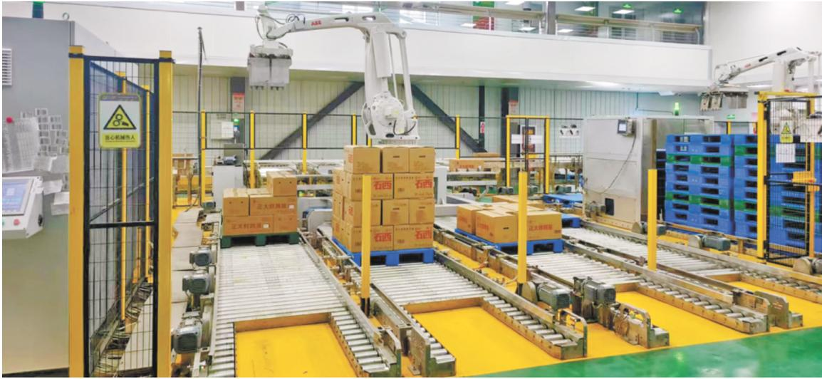
由跨国企业正大集团在潍坊安丘投资建设的正大(潍坊)360万蛋鸡全产业链项目，是目前全球集成规模最大、配套最全、最具科技性、示范性的安全生态全产业链食品项目。图为该项目食品车间内，生产线实现自动码垛。
