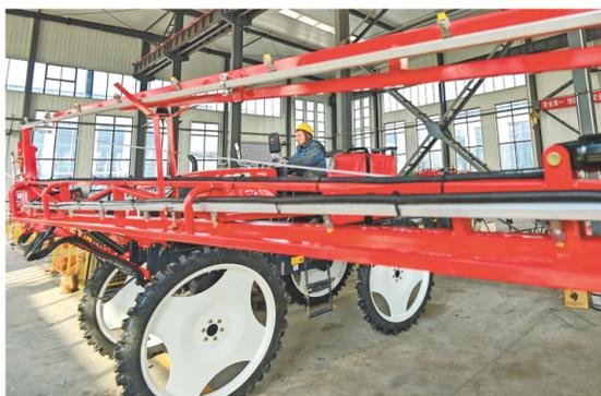
2月20日,在青州经济开发区一家农业机械制造企业,工人在调试大型宽幅喷杆喷药机。(□新华社发)
