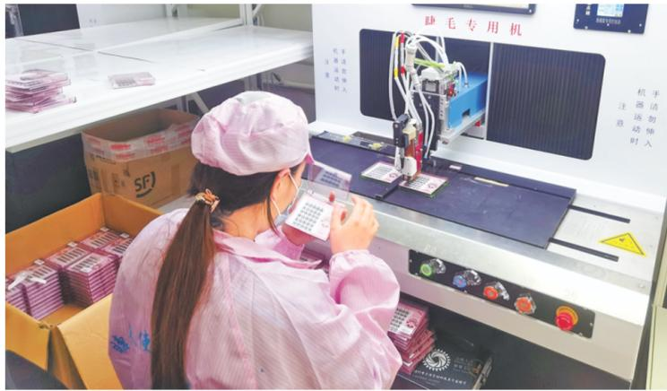
在安法译的工厂，假睫毛自动点胶机让生产效率大幅提升。
