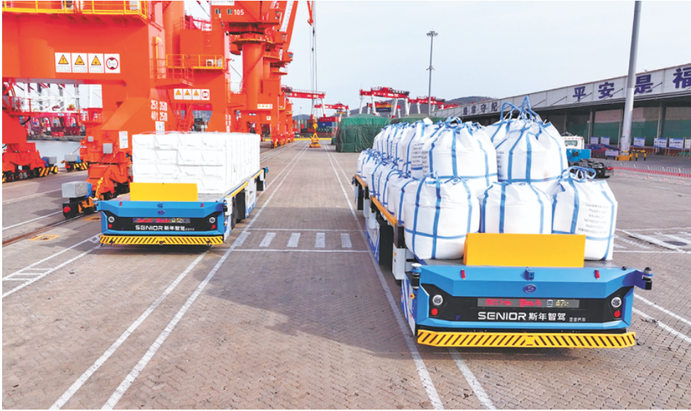
在山东港口青岛港西联公司，无人驾驶IGV满载货物从接卸区域驶向库场。
