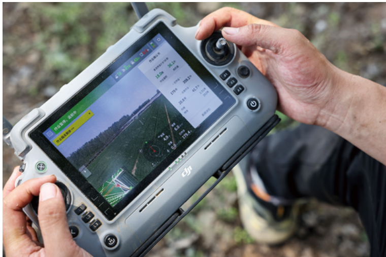
植保无人机上有监控摄像头，通过遥控器屏幕可以查看实时影像和无人机的各种数据。
