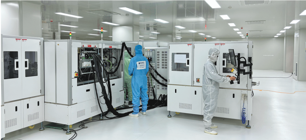
在元山（济南）电子科技有限公司，工作人员正在调试车规级碳化硅功率模组量产线。
