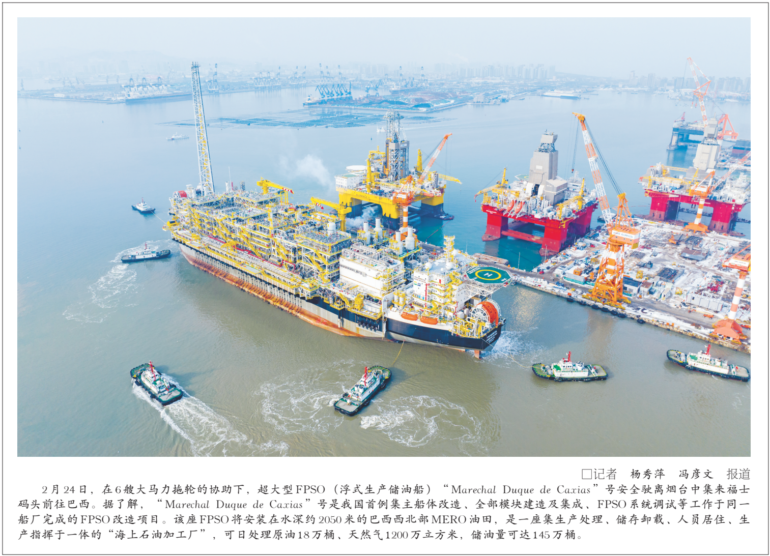
2月24日，在6艘大马力拖轮的协助下，超大型FPSO（浮式生产储油船）“Marechal Duque de Caxias”号安全驶离烟台中集来福士码头前往巴西。据了解，“Marechal Duque de Caxias”号是我国首列集主船体改造、全部模块建造及集成、FPSO系统调试等工作于同一船厂完成的FPSO改造项目。该座FPSO将安装在水深约2050米的巴西西北部MERO油田，是一座集生产处理、储存卸载、人员居住、生产指挥于一体的“海上石油加工厂”，可日处理原油18万桶、天然气1200万立方米，储油量可达145万桶。
