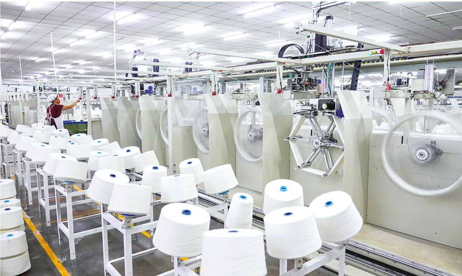
山东圣润纺织有限公司自主研发的全自动智能捻纱机性能指标世界领先，创新性地解决了捻纱工序的难点，降低了工人劳动强度，节省用工75%，提升生产效率50%，增加产量约50%。
