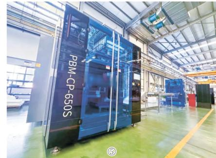
双模高速连续式BFS设备究竟有何优势？开启该设备单循环模式时，可同时生产120支产品，速度高达每小时45000支，相较于传统设备，生产速度提升数倍。而且设备材料利用率达80%，单支产品材料成本大幅降低。且每种规格的材料都能达到最大利用率，为企业创造最大价值。
