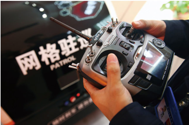
民警可以用遥控器对智能警务机器人进行手动模式与自动巡逻模式的切换。
