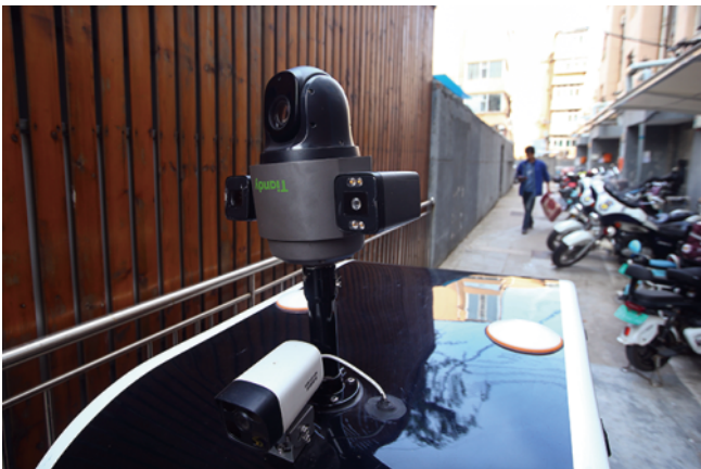
巡逻过程中，智能警务机器人身上的监控摄像头可以实现360度无死角全方位移动视频监控，并实时上传。
